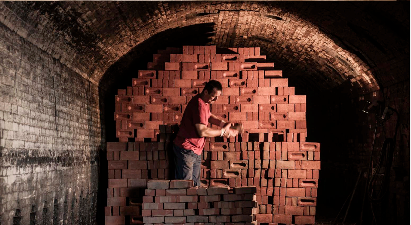
Ручная формовка кирпича и обжиг в старинной печи
